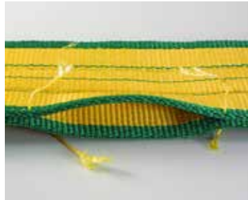
○縫い糸が切断され、ベルト幅以上に剥離している
