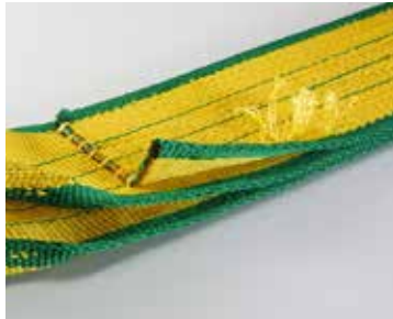
○目立った切り傷、すり傷、ひっかけ傷がある ○縫い糸が切断し、ベルトの剥離が少しでもある
