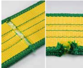
○損傷が進み、表面の黄色の糸、緑のフチを越え、 白い糸が露出している
