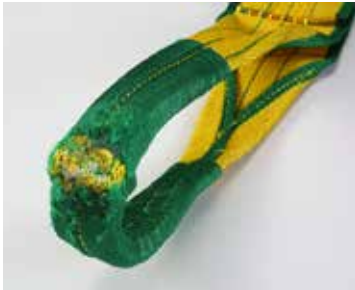
○カバーが著しく損傷し縦糸が露出し損傷がある ○縫い糸が切断し、アイの形状が保たれていない
